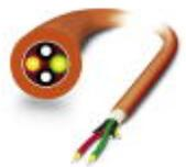
Konfektionierbare, robuste PCF-Installationsleitung (nur IP20-Köpfe) für Verlegung in stationären Anlagen und Maschinen, Aramid-Zugentlastungselemente, Einzelelemente aus FRNC-Material, halogenfrei, Ozon- und UV-beständig, mit Polyurethan-(PUR)-Außenmantel
