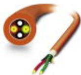
Konfektionierbare, robuste GOF-Installationsleitung für den Innenbereich mit hochreißfesten Aramid-Zugentlastungselementen. Einzelelemente bestehen aus hochflexiblem FRNC-Material. Die Leitung ist halogenfrei, Ozon- und UV-beständig mit einem robuste Polyurethan (PUR) Außenmantel.
