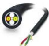
Konfektionierbare, hochrobuste GOF-Rundleitung (nur IP20-Köpfe) für die Außenverlegung mit integrierter Dampfsperre sowie nagetierfester Glasgarnlage. Einzelelemente aus hochflexiblem FRNC-Material. Die Leitung ist Ozon- und UV-beständig mit sehr robustem Polyethylen-Außenmantel.
