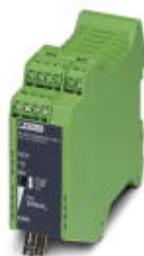
LWL-Konverter mit integrierter optischer Diagnose, Alarmkontakt, für RS-485 2-Draht-Bussysteme (SUCONET K, Modbus ...) bis 500 kBit/s, NRZ-Kodierung, Endgerät mit einer LWL-Schnittstelle (BFOC), 850 nm, für PCF-/Glasfaserkabel (Multimode)
