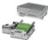
D-SUB-Stecker, 9-polige Buchse, zwei Kabelzuführungen unter 35°, Bussystem: MODBUS, CEGELEC; Pinbelegung: 1, 1, 2, 3, 6, 7; Schraubanschlussklemmen
