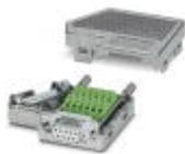
D-SUB-Stecker, 9-polige Buchse, zwei Kabelzuführungen unter 35°, Bussystem: CAN, SUCONET K1, K2 (MOELLER), S-BUS (Saia), J-BUS (Merlin Gerin), Pinbelegung: 2, 3, 4, 5, 7, 9 auf je zwei Schraubanschlussklemmen
