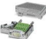
D-SUB-Stecker, 9-polig, Stift, zwei Kabelzuführungen unter 35°, Bussystem: CAN, SUCONET K1, K2 (MOELLER), S-BUS (Saia), J-BUS (Merlin Gerin), Pinbelegung: 2, 3, 4, 5, 7, 9 auf je zwei Schraubanschlussklemmen
