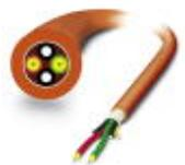
Konfektionierbare, robuste GOF-Installationsleitung (nur IP20-Köpfe) für Verlegung in stationären Anlagen und Maschinen, Aramid-Zugentlastungselemente, Einzelelemente aus FRNC-Material, halogenfrei, Ozon- und UV-beständig, mit Polyurethan-(PUR)-Außenmantel
