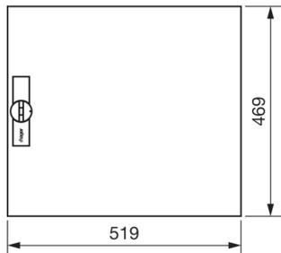
**Tür, univers, rechts, geschlossen, RAL 9010, für Schrank IP44 500x550mm**
