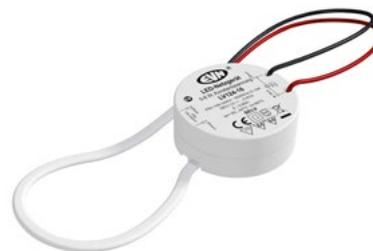
Der kurzschlussfeste Sicherheitstransformator lässt sich auf Grund der kleinen Bauform perfekt in Schalterdosen verbauen, kann aber auch beim Möbelbau zum Einsatz gebracht werden, da die MM-Kennzeichnung gegeben ist. Die Anschlussleitungen haben eine Länge von 15cm primärseitig und 17cm sekundärseitig. Technische Daten: Versorgungsspannung: 100-240V/AC, ta: -20°C - 50°C, tc: 80°C, Powerfaktor: 0,90.
