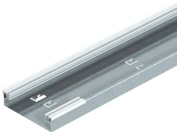
Aufflur-Installationskanal-Unterteil, 1-zügelig, für Blind-/Montagedeckel mit einseitiger Abschrägung, mit aufsteckbaren Aluminium-Seitenprofilen zum Auflagern und Befestigen der Kanaldeckel, Bodenwanne mit Haltetaschen für max. 2 einsteckbare, selbstkontaktierende Trennstege und Prägung für Schutzleiteranschlusswinkel. Kanalhöhe geeignet zum Aufbau von Teiltanks.
