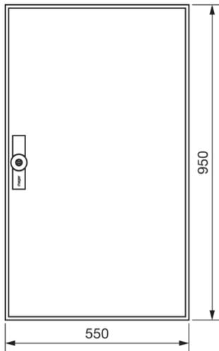
**Zählerschrank, univers Z, 950x550x205 mm, Schutzklasse II, 144 Platzeinheiten**
