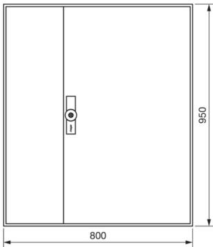
**Zählerschrank, univers Z, 950x800x205 mm, Schutzklasse II, 216 Platzeinheiten**
