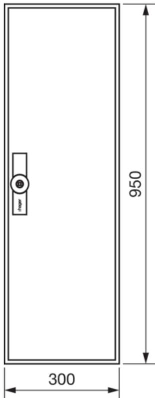
**Zählerschrank, univers Z, 950x300x205 mm, Schutzklasse II, 72 Platzeinheiten**
