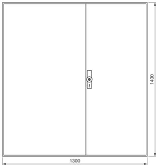
**Zählerschrank, univers Z, 1400x1300x205 mm, Schutzklasse II, 540 Platzeinheiten**
