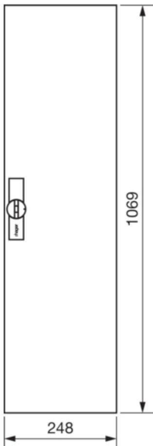
**Sondertür, univers, voll, rechts, RAL 9010, für Schrank IP44, 1100x300mm**
