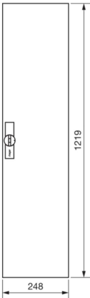
**Sondertür, univers, voll, rechts, RAL 9010, für Schrank IP44, 1250x300mm**
