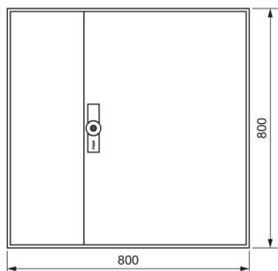
**Zählerschrank, univers Z, 800x800x205 mm, Schutzklasse II, 180 Platzeinheiten**
