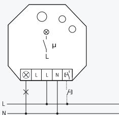
**1 Schließer nicht potenzialfrei 10A/250V AC, Glühlampen 2000 Watt, Rückfallverzögerung mit Ausschaltvorwarnung und Taster-Dauerlicht zuschaltbar. Verschlüsselter Funk, bidirektonaler Funk und Repeater-Funktion zuschaltbar. Stand-by-Verlust nur 0,8 Watt.**
