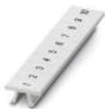
Zackband, Streifen, weiß, beschriftet, längs bedruckt: fortlaufende Zahlen 1-10, 11-20 usw. bis 491-500, Montageart: verrasten in hoher Schildchennut, für Klemmenbreite: 5,2 mm, Schriftfeldgröße: 5,15 x 10,5 mm
