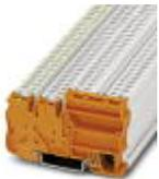
Installationsschutzleiterklemme, Nennspannung: 250 V, Nennstrom: 30 A, Anschlussart: Zugfederanschluss, Anzahl der Anschlüsse: 4, Querschnitt: 0,08 mm<sup>2</sup> - 4 mm<sup>2</sup>, AWG: 28 - 12, Breite: 10,4 mm, Farbe: orange, Montageart: NS 35/7,5, NS 35/15
