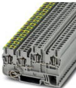
Installationsschutzleiterklemme, Nennspannung: 250 V, Nennstrom: 18 A, Anschlussart: Zugfederanschluss, Anzahl der Anschlüsse: 4, Querschnitt: 0,08 mm<sup>2</sup> - 4 mm<sup>2</sup>, AWG: 28 - 12, Breite: 5,2 mm, Farbe: grau, Montageart: NS 35/7,5, NS 35/15
