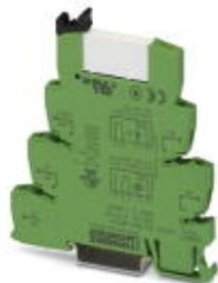
PLC-INTERFACE, bestehend aus Grundklemme PLC-BSC.../21 mit Schraubanschluss und steckbarem Miniaturrelais mit Mehrlagen-Goldkontakt, zur Montage auf Tragschiene NS 35/7,5, 1 Wechsler, Eingangsspannung 48 V DC
