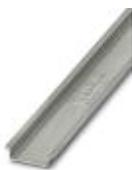
Tragschiene ungelocht, Standardprofil, Breite: 35 mm, Höhe: 7,5 mm, nach EN 60715: 2001, Material: Stahl, verzinkt, dickschichtpassiviert, Länge: 2000 mm, Farbe: silberfarben
