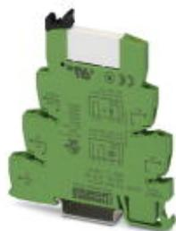
PLC-INTERFACE, bestehend aus Grundklemme PLC-BSC.../21 mit Schraubanschluss und steckbarem Miniaturrelais mit Mehrlagen-Goldkontakt, zur Montage auf Tragschiene NS 35/7,5, 1 Wechsler, Eingangsspannung 60 V DC
