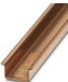
Tragschiene ungelocht, Standardprofil, Breite: 35 mm, Höhe: 15 mm, ähnlich EN 60715: 2001, Material: Kupfer, unbeschichtet, Länge: 2000 mm, Farbe: kupferfarben
