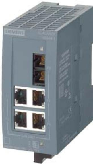
SCALANCE XB004-1 unmanaged Industrial Ethernet Switch für 10/100 Mbit/s; zum Aufbau von kleinen Stern- und Linienstrukturen; LED-Diagnose, IP20, AC/DC 24V Spannungsversorgung, mit 4x 10/100 Mbit/s Twisted Pair Ports mit RJ45-Buchsen; 1 x 100 Mbit/s Multimode Glas LWL-Port mit SC-Buchse; Handbuch als Download verfügbar
