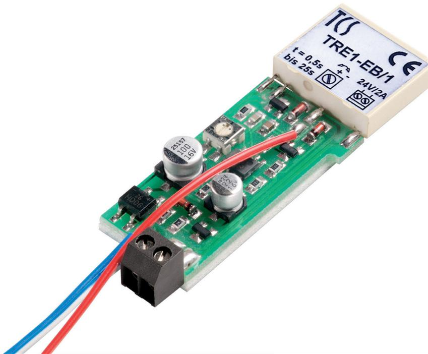
Einbau in die Unterschale der Innenstationen ISx3x30-0140
