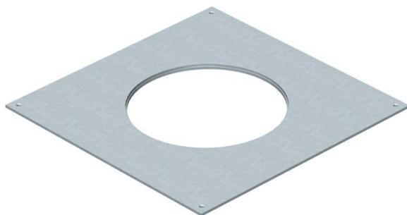
Montagedeckel für Unterflur-Zug- und -Abzweigdosens vom Typ UZD350-3 zum Einbau einer Einbaueinheit der Nenngröße R4. Einbauöffnung 3 mm vertieft zum nachträglichen Blindverschluss mit Deckelblindplatte.
