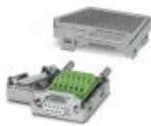
D-SUB-Stecker, 9-polige Buchse, zwei Kabelzuführungen unter 35°, Bussystem: CAN, SUCONET K1, K2 (MOELLER), S-BUS (Saia), J-BUS (Merlin Gerin), Pinbelegung: 2, 3, 4, 5, 7, 9 auf je zwei Schraubanschlussklemmen
