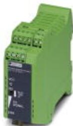
LWL-Konverter mit integrierter optischer Diagnose, Alarmkontakt, für RS-485 2-Draht-Bussysteme (SUCONET K, Modbus ...) bis 500 kBit/s, NRZ-Kodierung, Endgerät mit einer LWL-Schnittstelle (FSMA), 660 nm, für Polymer-/PCF-Faserkabel
