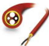
Konfektionierbare, robuste POF-Installationsleitung (nur IP20-Köpfe) für Verlegung in stationären Anlagen und Maschinen, Einzelelemente aus Polyamid (PE), halogenfrei, Ozon- und UV-beständig, mit verstärktem Polyurethan-(PUR)-Außenmantel
