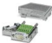
D-SUB-Stecker, 9-polig, Stift, zwei Kabelzuführungen unter 35°, Bussystem: CAN, SUCONET K1, K2 (MOELLER), S-BUS (Saia), J-BUS (Merlin Gerin), Pinbelegung: 2, 3, 4, 5, 7, 9 auf je zwei Schraubanschlussklemmen
