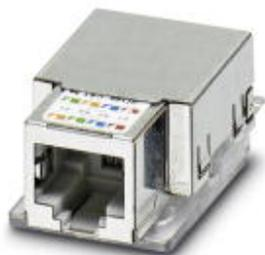
RJ45-Buchseneinsatz, Schutzart: IP20, Polzahl: 8, CAT5 (IEC 11801:2002), Material: Kupferlegierung, Anschlussart: IDC, Anschlussquerschnitt: AWG 24-22
