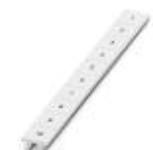
Zackband, Streifen, weiß, beschriftet, beschriftbar mit: CMS-P1-PLOTTER, quer bedruckt: fortlaufende Zahlen 1-10, 11-20 usw. bis 991-1000, Montageart: verrasten in hoher Schildchennut, für Klemmenbreite: 10,2 mm, Schriftfeldgröße: 10,15 x 10,5 mm
