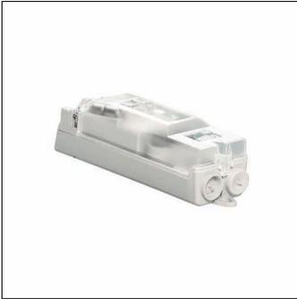
Kabelübergangskasten, für 3 Kabel bis 5x 16mm<sup>2</sup>, L1/L2/L3/L4/PE(N), 2x E14, aus Kunststoff, schlagfest, Mastinnendurchmesser: ab 89mm, Schutzart (gesamt): IP54, Schutzklasse (gesamt): SK II (Schutzisoliert), Prüfzeichen: CE, VDE, Verpackungseinheit: 1 Stück
