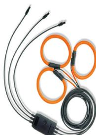
HTFLEX3003 ist ein Set mit 3 flexiblen Wandlern zur Messung von AC nach dem Rogowski-Prinzip bis 3000 A / 1000 A Leistungen: 300 / 3000 A (HTFLEX3003)
