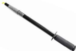
Teleskopstange ausziehbar 47 cm bis 85 cm, max. Strom 2 A, CATIII 1000 V mit 4 mm Anschlussbuchse und auswechselbarer Messspitze
