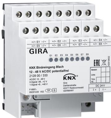
REG-Binäreingänge zum Anschluss von Kontakten. Die Schaltvorgänge von Kontakten (z. B. Wächter bzw. Taster) werden in KNX Telegramme umgesetzt. Die Eingänge können dabei unabhängig voneinander verschiedenen Funktionen zugeordnet oder gesperrt werden. Signalanzeige über gelbe Status-LED möglich.
