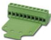
Steckerteil, Nennstrom: 12 A, Bemessungsspannung (III/2): 320 V, Polzahl: 12, Rastermaß: 5,08 mm, Anschlussart: Schraubanschluss mit Zughülse, Farbe: grün, Kontaktfläche: Zinn
