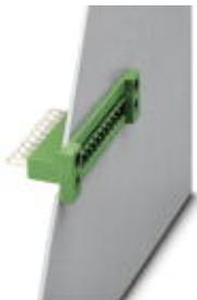
Grundgehäuse, Nennstrom: 12 A, Bemessungsspannung (III/2): 320 V, Polzahl: 12, Rastermaß: 5,08 mm, Anschlussart: Löt-/Flachsteckanschluss, Farbe: grün, Kontaktoberfläche: Zinn, Montage: Direktmontage, das Zubehörteil Art.-Nr. 5030172 ist nur in Verbindung mit MSTB 2,5/...ST-5,08 und MSTBT 2,5/...ST-5,08 verwendbar.
