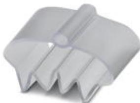
Ader-Bezeichnungsträger, transparent, unbeschriftet, Montageart: aufschieben, Kabeldurchmesserbereich: 22-30 mm, Schriftfeldgröße: 23 x 4 mm
