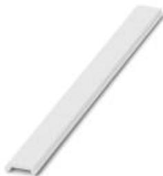
Zackband flach, Streifen, weiß, unbeschriftet, beschriftbar mit: CMS-P1-PLOTTER, PLOTMARK, Montageart: verrasten in flacher Schildchennut, für Klemmenbreite: 7,5 mm, Schriftfeldgröße: 5,15 x 7,4 mm
