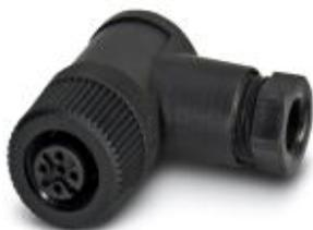
Steckverbinder, 5-polig, Buchse gewinkelt M12, A-kodiert, Schraubanschluss, Rändelmaterial: Kunststoff, Kabelverschraubung Pg7, Kabelaußendurchmesser 4 mm ... 6 mm
