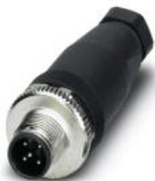
Steckverbinder, 5-polig, Stecker gerade M12, A-kodiert, Schraubanschluss, Rändelmaterial: Zinkdruckguss, vernickelt, Kabelverschraubung Pg7, Kabelaußendurchmesser 4 mm ... 6 mm
