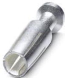
Gedrehter 4,0er Crimpkontakt, Buchsen-Einzelkontakt, Aderquerschnitt 2,50 mm<sup>2</sup>, versilbert
