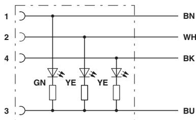
Kontaktbelegung des M12-Stecker und der M12-Buchse
