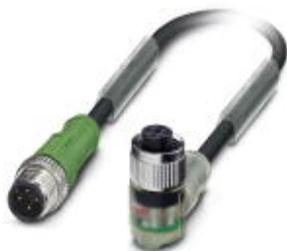
Sensor-/Aktor-Kabel, 4-polig, PUR halogenfrei, schwarzgrau RAL 7021, Stecker gerade M12, A-kodiert, auf Buchse gewinkelt M12, A-kodiert, mit 3 LEDs, Kabellänge: 0,3 m
