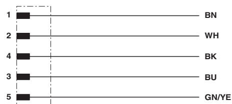
Kontaktbelegung des M12-Steckers
