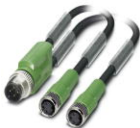
Sensor-/Aktor-Kabel, 3-polig, PUR halogenfrei, schwarzgrau RAL 7021, Stecker gerade M12, A-kodiert, auf Buchse gerade M8 und Buchse gerade M8, A-kodiert, Kabellänge: 1,5 m
