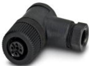
Steckverbinder, 4-polig, Buchse gewinkelt M12, A-kodiert, Schraubanschluss, Rändelmaterial: Kunststoff, Kabelverschraubung Pg7, Kabelaußendurchmesser 4 mm ... 6 mm
