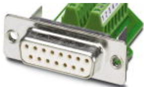
D-SUB-Kontakteinsatz, Shell-Größe 2, mit 15 Signalkontakten, Kontaktart Buchse, Schraubanschluss, gerade, für Anbaurahmen und Tüllengehäuse in Schutzart IP67
