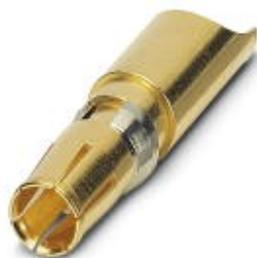
Power-Kontakte, für D-SUB-Kombinationseinsätze, Buchse, Lötkelch gerade, Bemessungsstrom 40 A, vergoldet
