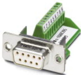
D-SUB-Kontakteinsatz, Shell-Größe 1, mit 9 Signalkontakten, Kontaktart Buchse, Schraubanschluss, gerade, für Anbaurahmen und Tüllengehäuse in Schutzart IP67
