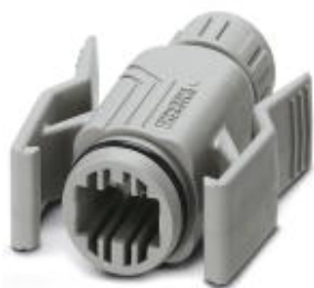
RJ45-Tüllengehäuse, IP67, für Stifteinsatz VS-08-ST-RJ45, mit Push-Pull-Verriegelung zum Anbauahmen, für Kabeldurchmesser 5,0 mm ... 6,5 mm
