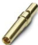
D-SUB-Crimpkontakt, Anschlussart: Crimpanschluss, Anschlussquerschnitt: AWG 24-20
