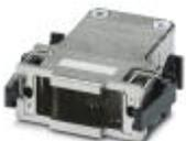
D-SUB-Tüllengehäuse, Schutzart: IP20, Material: ABS, metallisiert, Kabelabgang: gerade, Gehäusegröße: 2, Farbe: metallisch blank, Rasthakenverriegelung
