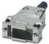
D-SUB-Tüllengehäuse, Schutzart: IP20, Material: Zink-Druckguss, Kabelabgang: gerade, Gehäusegröße: 2, Farbe: metallisch blank
