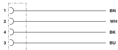
Kontaktbelegung der M12-Buchse
