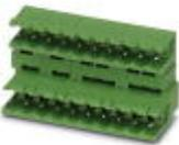
Grundgehäuse, Nennstrom: 10 A, Bemessungsspannung (III/2): 320 V, Polzahl: 5, Rastermaß: 5 mm, Farbe: grün, Kontaktfläche: Zinn, Montage: Wellenlöten, Anreihbar! Befestigungsflansch: Art.-Nr. 1736771, 1736768. Bei Kombination mit MVSTB- oder FKCV-Steckerteilen ist jeweils ein MVSTBW- (bzw. FKCVW-) und ein MVSTBR-Stecker (bzw. FKCVR-) zu verwenden. Kombination mit TMSTBP-Steckerteilen ist nicht möglich!
