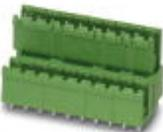
Grundgehäuse, Nennstrom: 10 A, Bemessungsspannung (III/2): 320 V, Polzahl: 5, Rastermaß: 5 mm, Farbe: grün, Kontaktfläche: Zinn, Montage: Wellenlöten, Anreihbar! Befestigungsflansch: Art.-Nr. 1836477, 1836480. Bei Kombination mit MVSTB- oder FKCV-Steckerteilen ist jeweils ein MVSTBW- (bzw. FKCVW-) und ein MVSTBR-Stecker (bzw. FKCVR-) zu verwenden. Kombination mit TMSTBP-Steckerteilen ist nicht möglich!
