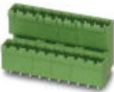
Grundgehäuse, Nennstrom: 10 A, Bemessungsspannung (III/2): 320 V, Polzahl: 5, Rastermaß: 5 mm, Farbe: grün, Kontaktfläche: Zinn, Montage: Wellenlöten, Der Artikel ist zu unterschiedlichen Polzahlen anreihbar! Bei Kombination mit MVSTB- oder FKCV-Steckerteilen ist jeweils ein MVSTBW- (bzw. FKCVW-) und ein MVSTBR-Stecker (bzw. FKCVR-) zu verwenden. Kombination mit TMSTBP-Steckerteilen ist nicht möglich!
