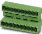
Grundgehäuse, Nennstrom: 10 A, Bemessungsspannung (III/2): 320 V, Polzahl: 5, Rastermaß: 5 mm, Farbe: grün, Kontaktfläche: Zinn, Montage: Wellenlöten, Der Artikel ist zu unterschiedlichen Polzahlen anreihbar! Bei Kombination mit MVSTB- oder FKCV-Steckerteilen ist jeweils ein MVSTBW- (bzw. FKCVW-) und ein MVSTBR-Stecker (bzw. FKCVR-) zu verwenden. Kombination mit TMSTBP-Steckerteilen ist nicht möglich!
