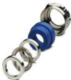
EMV-Halbverschraubung Pg21, für Metallgehäuse der Größen 2-4, bestehend aus Dichtgummi, Irisfeder, Konusscheiben und Druckschraube, für Gehäuse der Größe 1, Spannungsbereich Kabelschirm [mm] 9,5-13,5, Kabel [mm] 11,5-15,5
