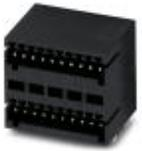
Grundgehäuse, Nennstrom: 4 A, Bemessungsspannung (III/2): 160 V, Polzahl: 7, Rastermaß: 2,5 mm, Farbe: schwarz, Kontaktoberfläche: Zinn, Montage: THR-Löten, Standardbauelement aus hochtemperaturfähigem Kunststoff; für Reflowprozesse geeignet. Anwenderinformationen und Designempfehlungen zur Through Hole Reflow Technologie finden Sie unter "Downloads"
