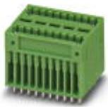
Grundgehäuse, Nennstrom: 4 A, Bemessungsspannung (III/2): 160 V, Polzahl: 7, Rastermaß: 2,5 mm, Farbe: grün, Kontaktoberfläche: Zinn, Montage: Wellenlöten
