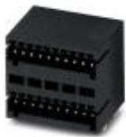
Grundgehäuse, Nennstrom: 4 A, Bemessungsspannung (III/2): 160 V, Polzahl: 9, Rastermaß: 2,5 mm, Farbe: schwarz, Kontaktoberfläche: Zinn, Montage: THR-Löten, Standardbauelement aus hochtemperaturfähigem Kunststoff; für Reflowprozesse geeignet. Anwenderinformationen und Designempfehlungen zur Through Hole Reflow Technologie finden Sie unter "Downloads"
