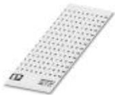
Kennzeichnungskarte, Karte, weiß, beschriftet, längs: fortlaufende Zahlen 1-10, 11-20 usw. bis 91-99, Montageart: kleben, für Klemmenbreite: 2,54 mm, Schriftfeldgröße: 2,54 x 2,8 mm
