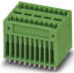
Grundgehäuse, Nennstrom: 4 A, Bemessungsspannung (III/2): 160 V, Polzahl: 9, Rastermaß: 2,5 mm, Farbe: grün, Kontaktoberfläche: Zinn, Montage: Wellenlöten
