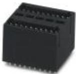
Grundgehäuse, Nennstrom: 4 A, Bemessungsspannung (III/2): 160 V, Polzahl: 9, Rastermaß: 2,5 mm, Farbe: schwarz, Kontaktoberfläche: Zinn, Montage: THR-Löten, Standardbauelement aus hochtemperaturfähigem Kunststoff; für Reflowprozesse geeignet. Anwenderinformationen und Designempfehlungen zur Through Hole Reflow Technologie finden Sie unter "Downloads"
