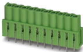
Grundgehäuse, Nennstrom: 16 A, Bemessungsspannung (III/2): 320 V, Polzahl: 9, Rastermaß: 5,08 mm, Farbe: grün, Kontaktfläche: Zinn, Montage: Wellenlöten, COMBICON-Steckverbinder dürfen nur leistungslos betätigt werden. Müssen aus betriebstechnischen Gründen kleinere Leistungen geschaltet werden, stehen auf Anfrage Erfahrungswerte zur Verfügung
