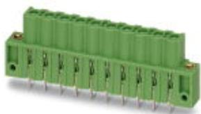
Grundgehäuse, Nennstrom: 16 A, Bemessungsspannung (III/2): 320 V, Polzahl: 10, Rastermaß: 5,08 mm, Farbe: grün, Kontaktfläche: Zinn, Montage: Wellenlöten, COMBICON-Steckverbinder dürfen nur leistungslos betätigt werden. Müssen aus betriebstechnischen Gründen kleinere Leistungen geschaltet werden, stehen auf Anfrage Erfahrungswerte zur Verfügung
