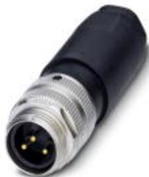
Steckverbinder, 3-polig, Stecker gerade 7/8"-16UNF, Schraubanschluss, Rändelmaterial: Zinkdruckguss, vernickelt, Kabelverschraubung Pg13,5, Kabelaußendurchmesser 10 mm ... 12 mm, Kontakt 1 voreilend
