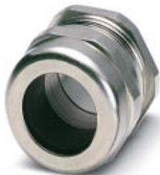
Metall-Verschraubung bis 5 bar, Gewindelänge: 8 mm, Kabeldurchmesser : 27 ... 34 mm, SW 50, Verschraubung: M40
